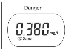
※ 測定結果が「0.250mg/L以上」の時は、表示部に「Danger」と表示されます。Dangerは危険を意味します。（警告音を止めるには、電源ボタンを長押しして電源をオフにしてください。）
