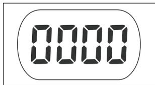
② 使用残数が終了すると測定不可能な状態となり、表示部に「0000」と表示されます。なお、購入後1年を経過した場合、使用残数の表示に関わらず、センサーの性能は著しく低下しますので、ご注意ください。
