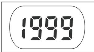
① 本体表面の電源ボタンを長押し、電源をオンにします。ブザー音が鳴り、表示部に使用可能残数が表示されます。初回使用時の表示は、「1999」で、測定にてアルコールを検知することに数字がカウントダウンされます。尚、アルコールが検知されない場合はカウントダウンされません。
