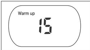
① 本体表面の電源ボタンを長押し、電源をオンにします。ブザー音が鳴り、表示部に「Warm up」と表示され、起動準備のカウントダウンが始まります。15カウント待機してください。
